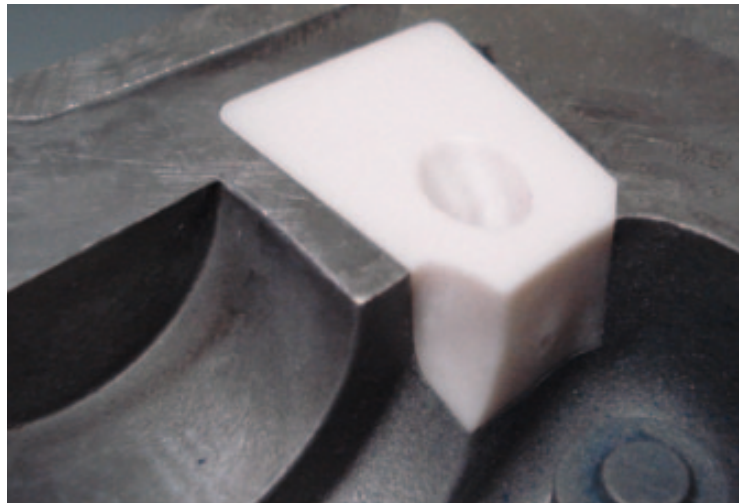
Formeinsätze: Die Dimacer-Keramik kann als verschleißfester Werkzeugeinsatz beim Metall- und Keramikspritzguss eingesetzt werden.
