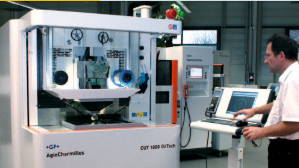
Die CUT 100 OilTech im Einsatz: Die Erodiermaschine von Agie Charmilles erodiert die Keramikwerkstücke im Ölbad. Das Öl sorgt für eine gute Oberflächenqualität.
